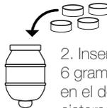
2. Inserte **5 pastillas** (de 6 gramos c/u) de cloro en el dosificador para cisterna de 5000 L.
