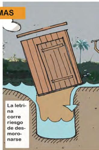
La letrina común si está construida a nivel del terreno, con las lluvias el agua entra y se erosionan los bordes puede ocasionar desmoronamientos y accidentes
